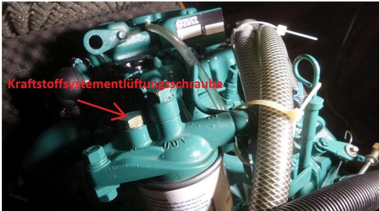
Über dem Motorölfilter befindet sich die Kraftstoffpumpe mit einem kleinen Hebel (ähnlich einem Pistolenabzug). Dieser Hebel muss nun ein einige 100 mal bewegt werden, das dauert wirklich locker 10 Minuten (man glaubt zwischenzeitlich, dass die Pumpe nicht pumpt oder man etwas falsch macht, dem ist aber nicht so.) Sobald an der Entlüftungsschraube Diesel austritt ist man fertig, die Entlüftungsschraube muss wieder verschlossen werden.
